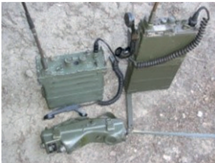
Radio AN/PRC 10 (RT-176/PRC-10) spaleggiabile a Modulazione di Frequenza (peso 4,1 kg)
