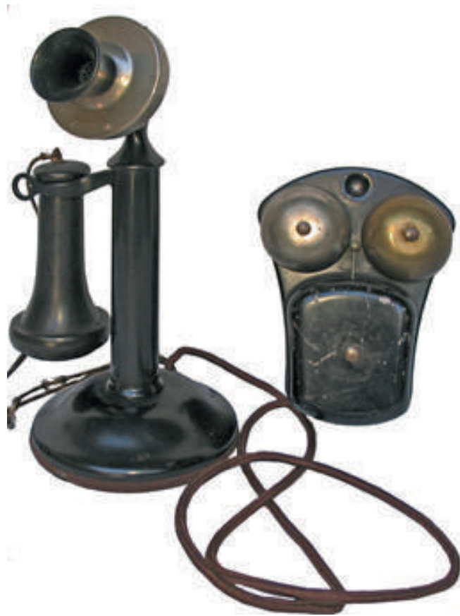
Telefono a batteria centrale stile candela del 1905 della ditta americana KELLOW
