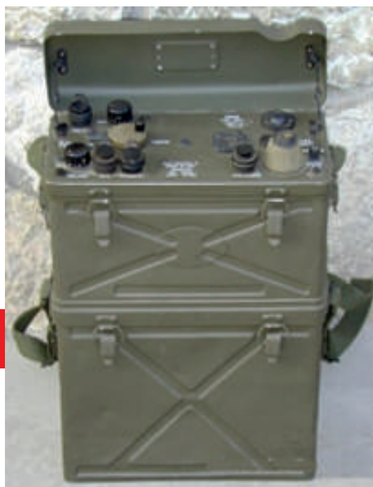
AN SCR 300 - BC 1000 a Modulazione di Frequenza a valvole, passata alla storia come prima Walkie-Talkie spalleggiabile
