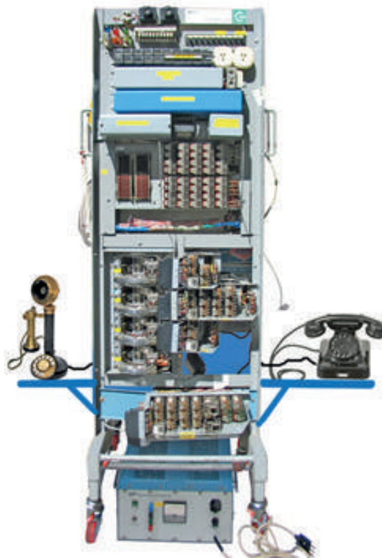
Centrale automatica elettromeccanica a sistema rotativo SIEMENS TM20 SNM2 del 1950
