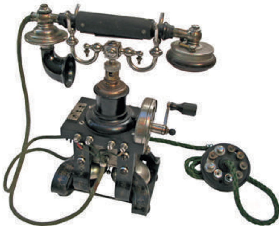
Telefono scheletrato denominato "RAGNO" del 1892 della casa costruttrice svedese ERICSSON a batteria locale. In uso a fine '800 presso il Vaticano.
