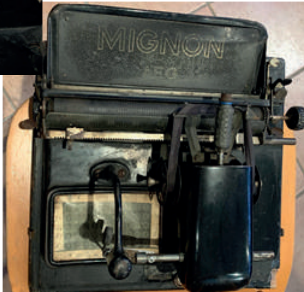
Macchina da scrivere ad un solo tasto AEG Mignon 1905 - 1934 Il quadrante e il cilindro portacaratteri erano sostituibili per l'adattamento ai diversi alfabeti
